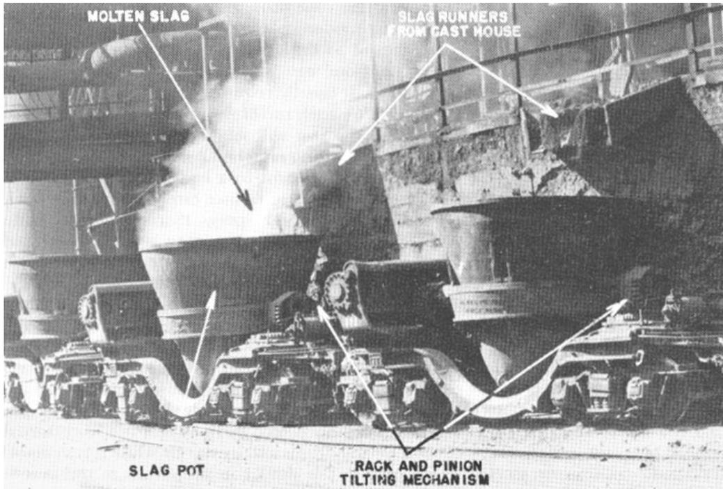
Fig. 9.53 Molten slag filling a slag pot.
