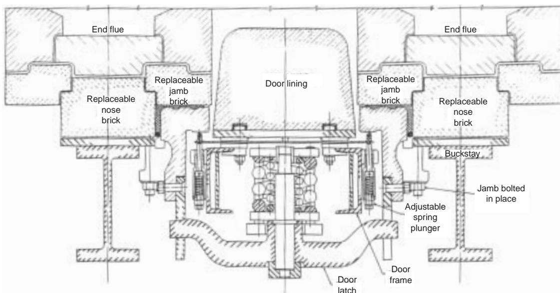
Fig. 7.28 Cross-section of a Wilputte door and door jamb arrangement.
