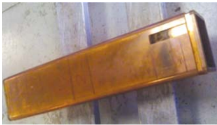
شکل ۲ - تیوب مسی آسیب دیده
