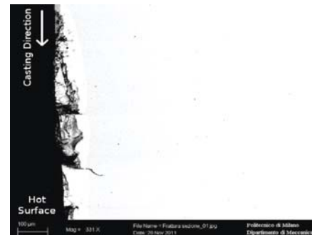
شکل ۶ - بررسی SEM در ناحیه آسیب‌دیده
