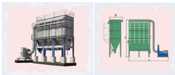
شکل 11- 11: تصاویری از غبارگیر خشک
