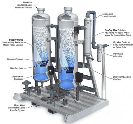
شکل 11-15: تصویری از یک خشک کن با روش جذب جامد
