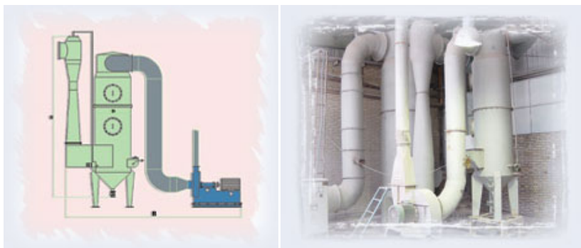
شکل 11- 12: تصاویری غبارگیر تر
