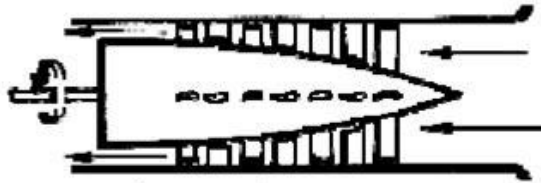
شکل 11-20: شبیه سازی ساده ای از نحوه حرکت سیال در کمپرسور جریان محوری
