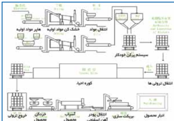
▲ فرآیند تولید آهن اسفنجی با روش تونلی
